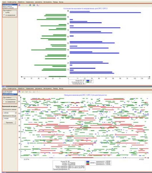
Модуль предназначен для контроля загрузки и эффективности использования каналов (СIC) разговорных маршрутов. Анализ производится по количеству занятий на канал, либо по времени занятия канала с разделением на входящий и исходящий. Используя анализ по причине разъединения, можно косвенно оценить качество отдельных каналов в маршруте.
