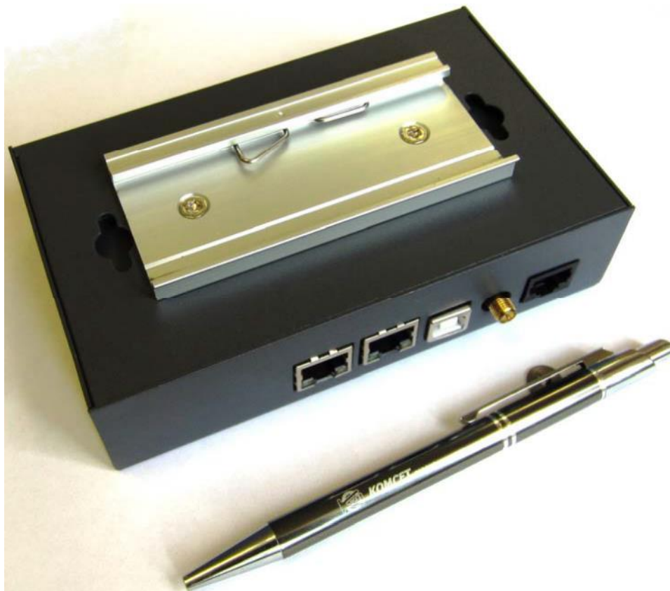
Рис. 2.5. Вид со стороны крепления на DIN-рейку устройства для установки в помещениях.
