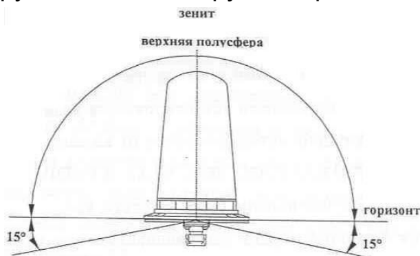
Рис.6.5. Верхняя полусфера антенны
